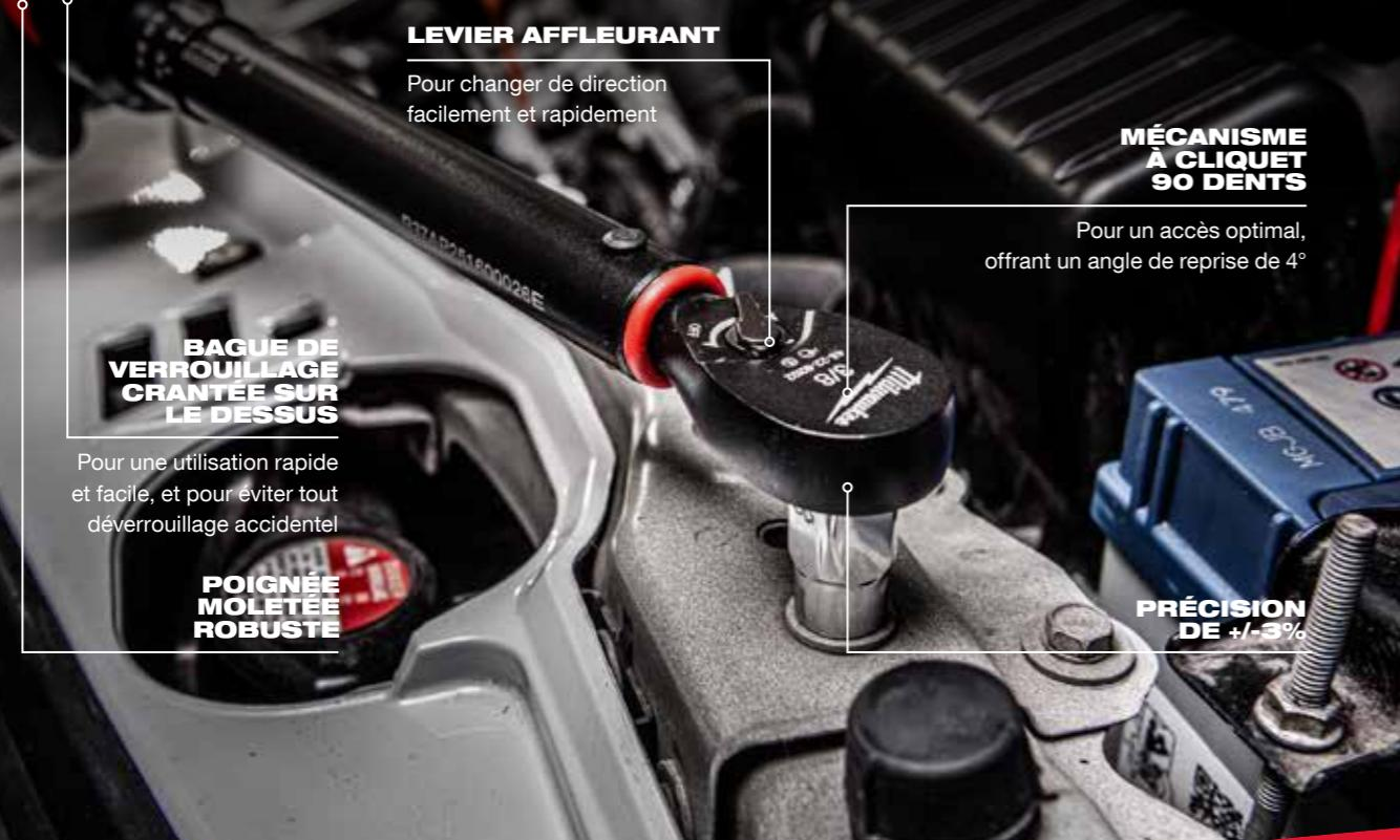
**CLÉ À CLIQUET DYNAMOMÉTRIQUE  $\frac{3}{8}$ " 10-50 NM**
